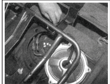
Рис. 17 Сняв панель в металлическом полу, отсоедините электрический разъем от топливного насоса - показана модель CR-V
