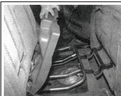
Рис. 16 Открутив винты, снимите крышку рамы сиденья вверх и выньте из автомобиля - показана модель CR-V
