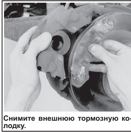
Рис. 14. Удерживая суппорт как показано, надавите на колодку и выдвиньте ее из суппорта.
