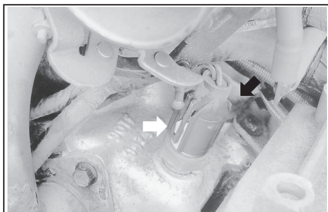
Большинство датчиков температуры охлаждающей жидкости (стрелка) устанавливается на впускном коллекторе
