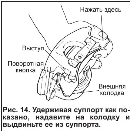
Снимите внешнюю тормозную колодку.
