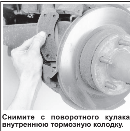
Рис. 14. Удерживая суппорт как показано, надавите на колодку и выдвиньте ее из суппорта.
