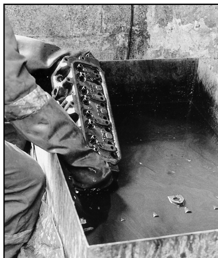
После обезжиривания головки в растворе каустической соды...
