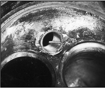
После ремонта резьбы пружинной вставкой нужно вырезать поврежденное седло и установить новое.
