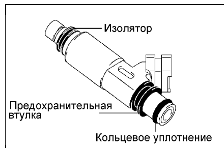
Форсунки (2UZ-FE с 2003 г.). 1 - верхняя защитная крышка, 2 - топливная трубка №3, 3 - регулятор давления топлива, 4 - кольцевое уплотнение, 5 - прокладка, 6 - топливная трубка №1, 7 - топливный коллектор №1, 8 - топливный коллектор №2, 9 - изолятор, 10 - форсунка, 11 - предохранительная втулка, 12 - проставка, 13 - электропневмоклапан, 14 - вакуумный шланг, 15 - шланг системы вентиляции картера, 16 - впускной воздуховод, 17 - шланг №2 повышения частоты вращения холостого хода, 18 - шланг системы вентиляции картера, 19 - проводка двигателя.
