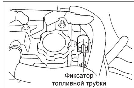
б) С помощью спецприспособления отсоедините топливную трубку.
