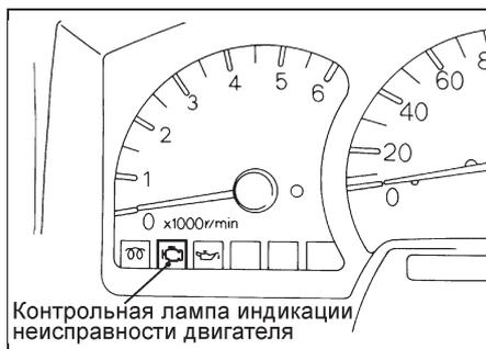
2. Если контрольная лампа не горит, то проверьте проводку, предохранитель и саму лампу.
