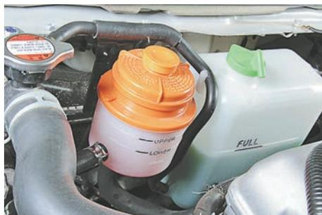
Если уровень рабочей жидкости находится ниже метки «MIN», долейте ее до отметки «MAX».
