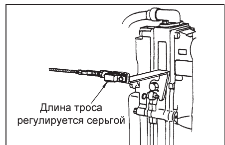
Схема управления двигателем грузовых автомобилей с электронным регулятором.
