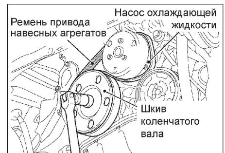
в) Отверните центральный болт крепления шкива (двигатель 4A90) или демпфирующего шкива (двигатель 4A91) коленчатого вала.
