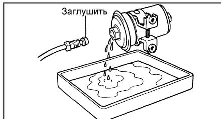
5. При снятии и установке форсунки и фланцевой трубки топливного коллектора всегда заменяйте соответствующую кольцевую прокладку новой.
