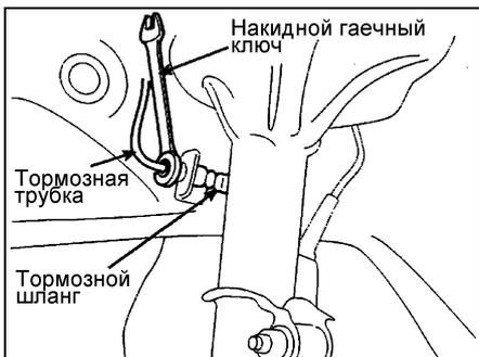
2. Извлеките фиксатор тормозного шланга с помощью плоскогубцев.
