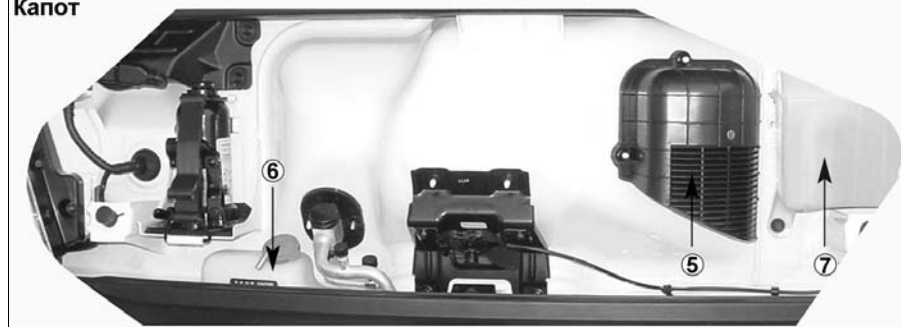
Расположение объектов обслуживания в моторном отсеке (Kia, двигатель J3 (2,9 л)). 1 - бачок системы усилителя рулевого управления, 2 - масляный щуп двигателя, 3 - крышка маслозаливной горловины, 4 - крышка радиатора, 5 - салонный фильтр, 6 - расширительный бачок системы охлаждения, 7 - бачок омывателя.
