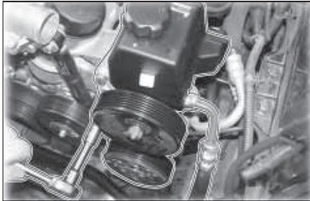
з) Отсоедините трубки от компрессора кондиционера.
