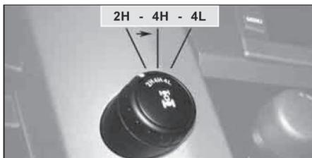
В положении "2H" в раздаточной коробке включен режим 2WD и привод осуществляется только на задние колеса. При положении "4H" переключателя включается режим 4WD и привод осуществляется на четыре колеса и включена прямая передача в раздаточной коробке. При положении "4L" переключателя включен режим 4WD и пониженная передача в раздаточной коробке.
