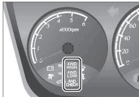
Индикатор "4WD HIGH" загорается при включении полного привода и гаснет при его выключении. Индикатор "4WD LOW" загорается при включении пониженной передачи и гаснет при ее выключении. Индикатор "4WD CHECK" загорается в случае возникновения неисправности в системе управления раздаточной коробкой.
