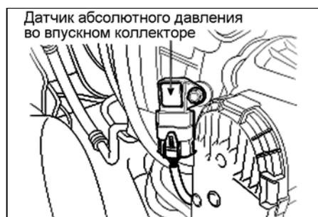
2. С помощью мультиметра измерьте сопротивление между выводами "4" ("масса") и "3" (сигнал) разъема датчика.
