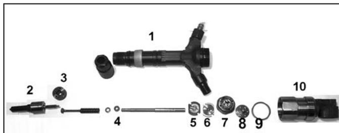
Фото 3. 1 - корпус форсунки, 2 - распылитель, 3 - пружина (правее распылителя), 4 - плунжер мультипликатора, 5, 6, 7, 8 - элементы камеры управления, 9 - регулировочное кольцо, 10 - электроклапан.
