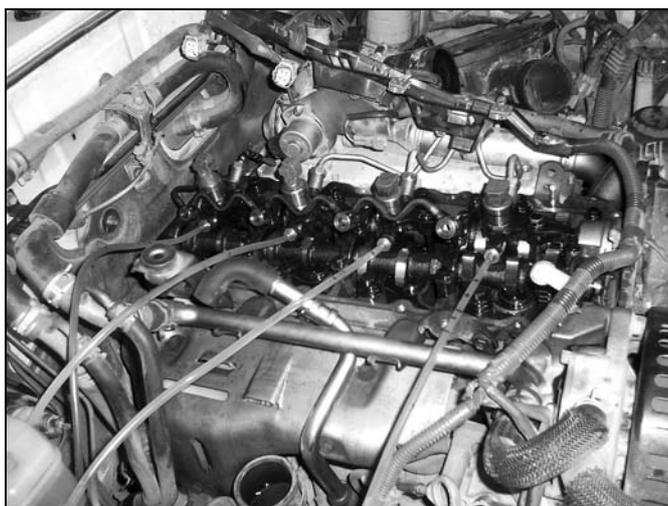
Фото 2. (Фото 1 и 2 отображают процесс измерения "перетока" топлива по линии "обратки" форсунок при работающем двигателе и в момент его "остановки").
