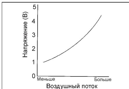
Если изменение напряжения сигнала отличается от установленного, замените датчик.
