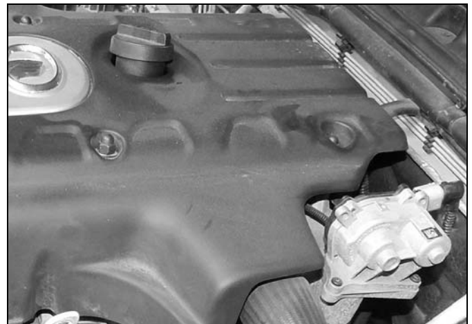
Расположение электропривода клапана EGR на Great Wall Hover H5 с дизельным двигателем.
