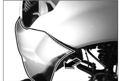
11. Потяните за передний бампер и снимите его.
