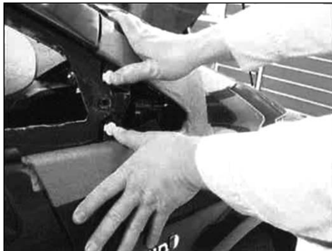
Установка новых фиксаторов переднего крыла.
