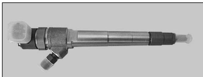
Неисправные форсунки можно отремонтировать в специализированной мастерской, при этом после ремонта вы должны получить новые корректирующие коды и прописать их в памяти блока управления двигателем. Корректирующий код для форсунки выдает стенд, если код не выдается, то ремонт выполнен неудовлетворительно.
