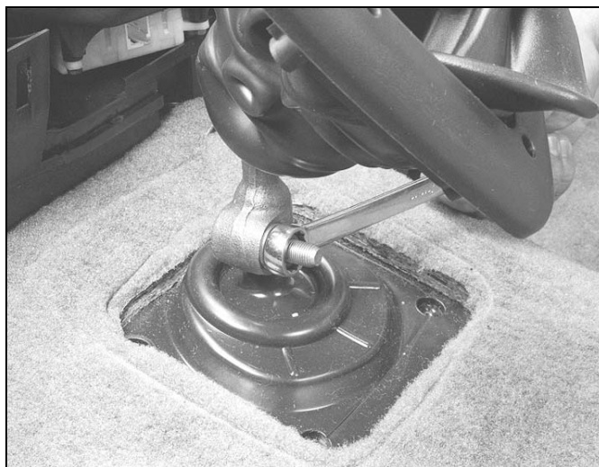
2.2а Отверните гайку крепления рычага и наверните её на другой конец шпильки...
