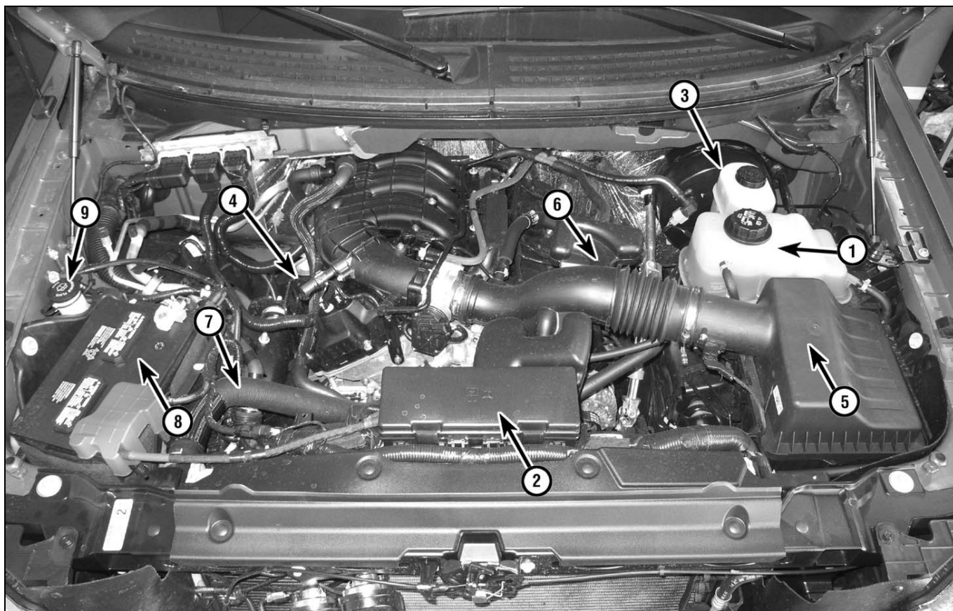
Расположение компонентов под капотом (показана модель с двигателем 3.7 л). 1 - расширительный бачок системы охлаждения, 2 - подкапотный блок предохранителей и реле, 3 - резервный бачок тормозной жидкости, 4- шланг вентиляции картера, 5 - корпус воздушного фильтра, 6 - масляный щуп двигателя, 7 - верхний шланг радиатора, 8 - аккумуляторная батарея, 9 - резервный бачок омывателя.
