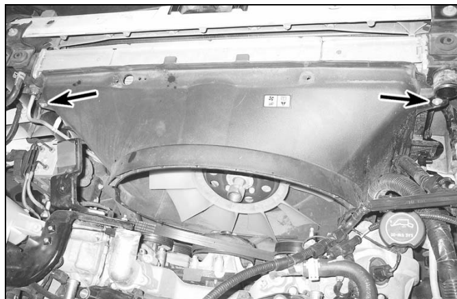
4.11 Отверните болты крепления кожуха и снимите его вместе с узлом муфты и крыльчатки вентилятора.
