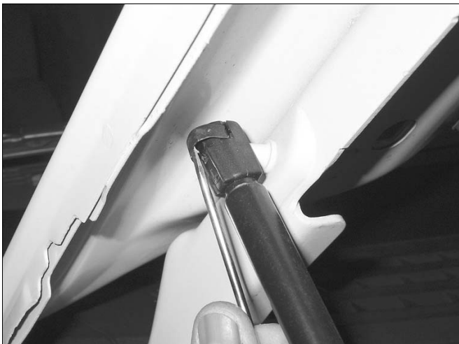
9.2 Используя тонкую отвёртку, снимите пружинные фиксаторы с двух сторон стойки и отсоедините стойку от шарниров.
