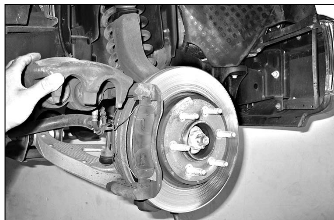
3.6в ...разверните суппорт вверх и подвяжите его проволокой к пружине подвески. Не оставляйте висеть суппорт на тормозном шланге.
