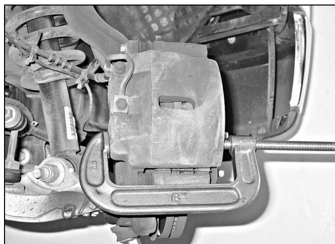
3.5 Перед снятием суппорта протолкните поршень внутрь цилиндра, чтобы обеспечить место для новых колодок. Для этого можно использовать струбцину.
