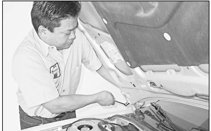
10.4 Отворачивая болты крепления петель, поддерживайте капот плечом.
