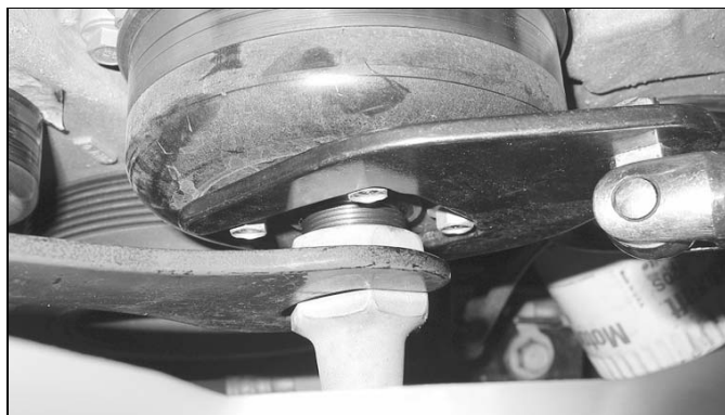
4.10б Удерживая шкив, отверните против часовой стрелки большую гайку крепления узла муфты с крыльчаткой.
