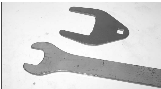
4.10.a Для снятия муфты потребуется комплект специальных тонких рожковых ключей.
