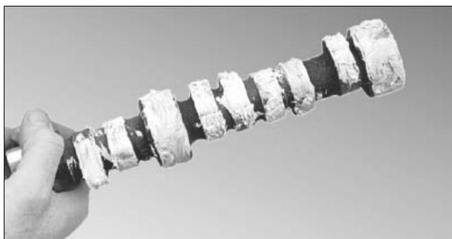
12.11. Перед монтажом распределительного вала смажьте шейки вала и кулачки сборочной смазкой.
