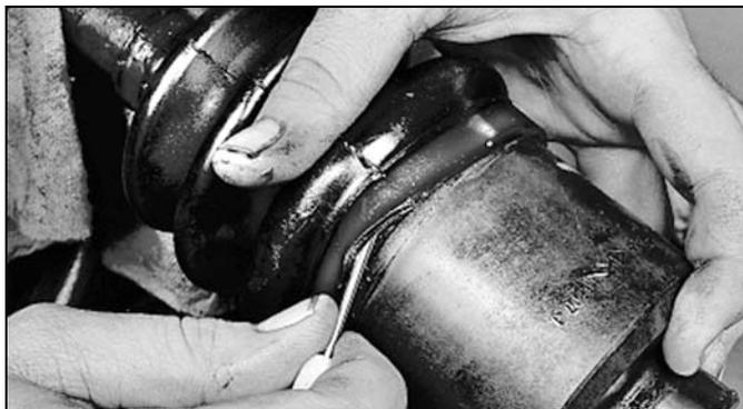
14.19. Установите шарнир на половину его хода, выровняйте давление в чехле круговым движением малой отвертки.
