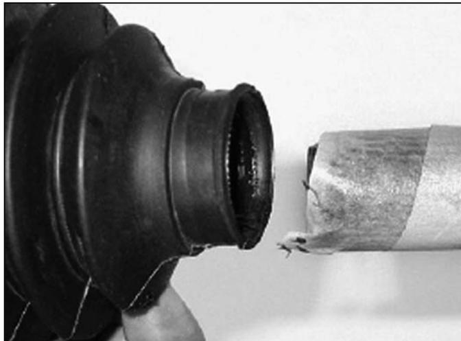
14.12. Оберните шлицы вала лентой, чтобы предотвратить повреждение чехла при установке его на вал.
