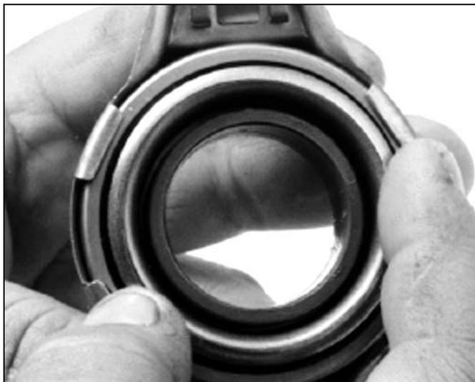
5.5. Проверка выжимного подшипника.
