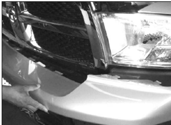
13.6b. ...затем отсоедините центр панели и снимите панель.
