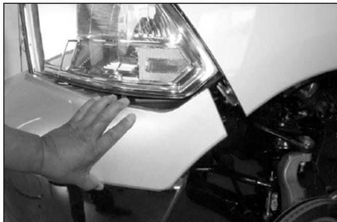
13.6a. Малой отверткой отстегните боковую клипсу и потяните накладку бампера на себя,...
