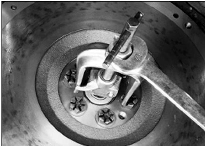
6.5. Чтобы снять направляющий подшипник, используйте специальный экстрактор, предназначенный для этой цели.
