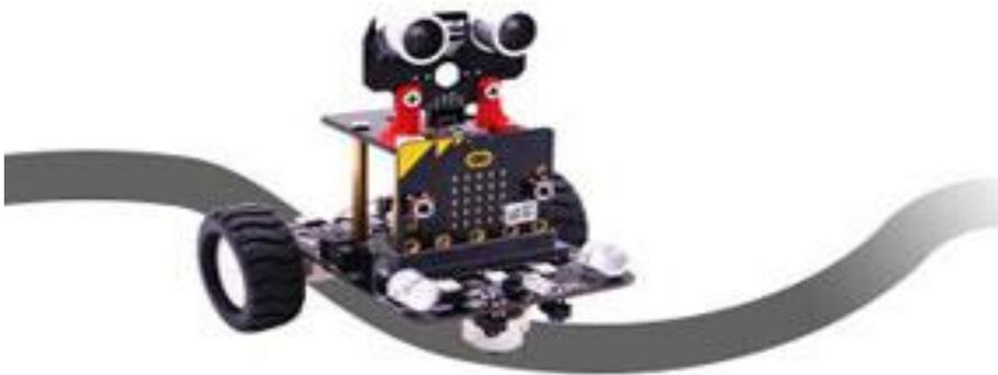
Поставьте робот на предварительно нанесенную линию черного цвета (или используйте трек из вашего конструктора), после чего нажмите кнопку “Tracking mode”. Робот начнет движение, следуя линии. Для отключения данного режима повторно нажмите кнопку “Tracking mode”.
