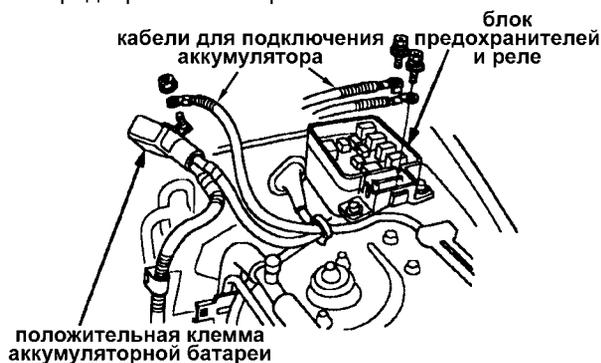
5. Снимите аккумуляторную батарею и кронштейн крепления аккумуляторной батареи.
