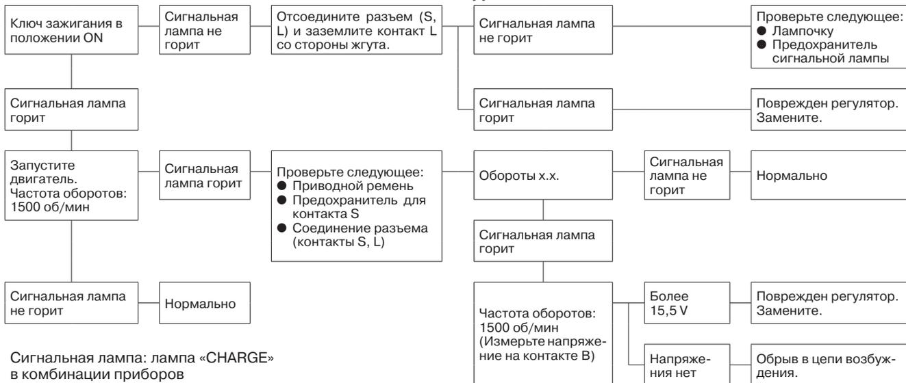
Сигнальная лампа: лампа «CHARGE» в комбинации приборов
