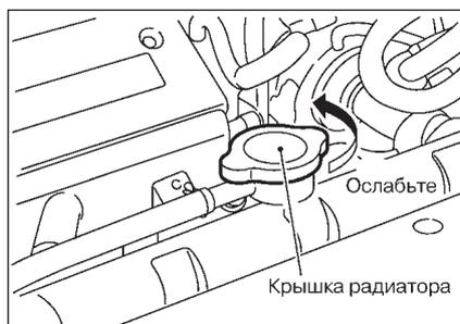
3. Снимите бачок и слейте охлаждающую жидкость.
