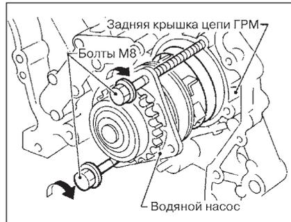
9. Затяните болты М8, поочередно закручивая их на пол-оборота до тех пор, пока они не коснутся задней крышки цепи ГРМ.
