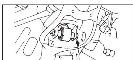
в) Отсоединение и подсоединение тяги датчика контроля высоты передней подвески, смотрите соответствующие параграфы раздела "Ступица и поворотный кулак передней подвески".
