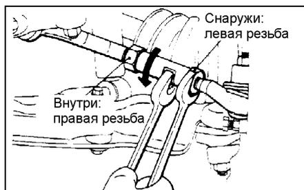
3. После выполнения регулировок убедитесь, что углы поворота колес и количество поворотов рулевого колеса от упора до упора находятся в пределах номинальных значений. (См. главу "Рулевое управление").
