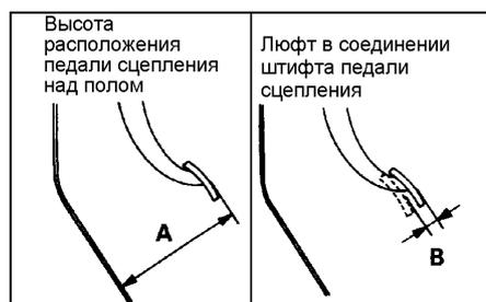
2. Если расстояние педали сцепления до пола или люфт в соединении штифта педали сцепления (с отверстием под шплинт) с толкателем главного цилиндра сцепления лежит за пределами диапазона номинальных значений, то выполните регулировку в соответствии со следующими процедурами:
