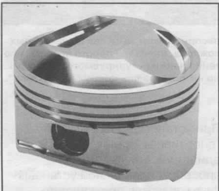
Поршни бывают различных размеров и форм. Этот поршень имеет верхнюю часть купольной формы с проточками под клапаны.
