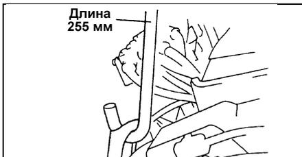
в) Установите спецприспособления, как показано на рисунке и вывесьте двигатель.
