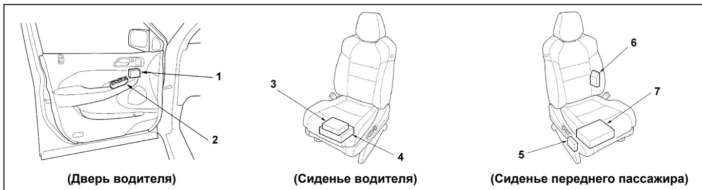
Расположение блоков управления. 1 - блок управления стеклоподъемниками, 2 - блок управления MULTIPLEX в двери водителя, 3 - блок управления положением сиденья водителя, 4 - CD-чейнджер (модели с системой DVD для задних пассажиров), 5 - датчик наличия пассажира на сиденье, 6 - блок системы определения положения переднего пассажира, 7 - электронный блок навигационной системы.
