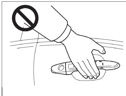
5. На задних боковых дверях установлена дополнительная блокировка дверей. Данная функция позволяет запереть дверь так, что она может быть открыта только снаружи. Рекомендуется использовать эту функцию каждый раз, когда в автомобиле находятся маленькие дети. Для включения переместите запорный рычаг в положение "LOCK".
