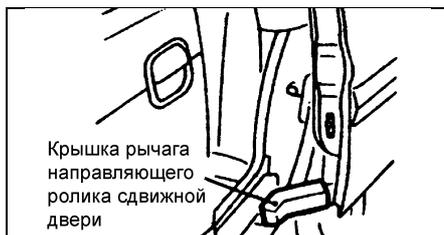
Крышка рычага направляющего ролика сдвижной двери
