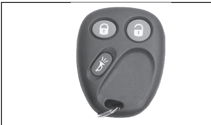
Брелок-передатчик системы дистанционного управления центральным замком.
