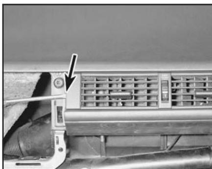
Рис. 30.14,б. ...затем выверните винт (показан стрелкой)
