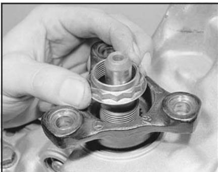
Рис. 4.15. Гайка крепления выходного фланца трансмиссии
