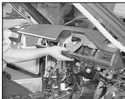
Рис. 30.16,в ...и снимите лицевую панель с автомобиля
