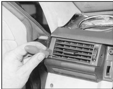
Рис. 30.11,а. Отожмите фиксаторы...
