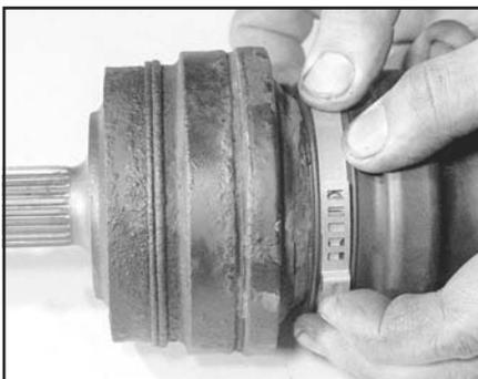
**Рис. 6.17,а.** Натяните и зафиксируйте хомут на чехле
