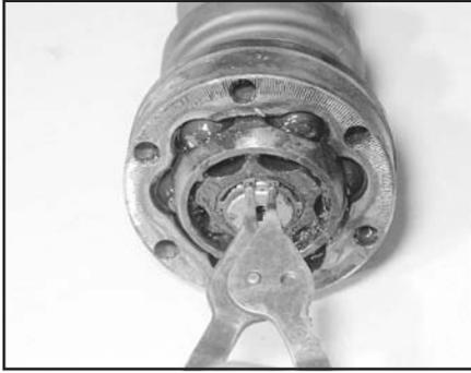
**Рис. 6.5.** Извлеките стопорное кольцо и выведите или вытяните внутренний шарнир с торца ведущего вала
