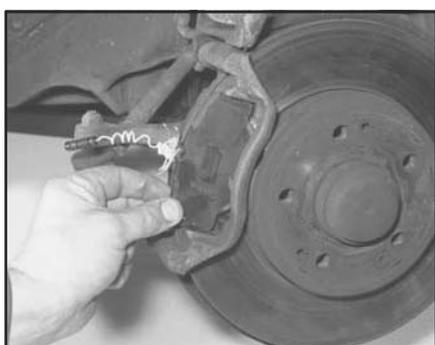
**Рис. 4.6.** Снимите колодки с опорного кронштейна суппорта
