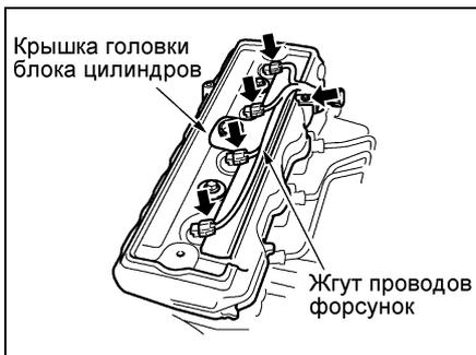
б) Отверните два болта и снимите крышку головки блока цилиндров, 2 прокладки и 2 подушки с головки блока цилиндров.
