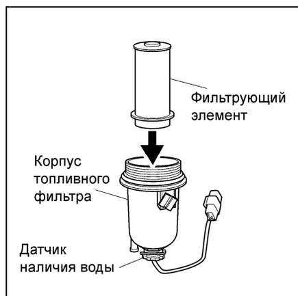
11. Заверните корпус топливного фильтра до упора. Убедитесь, что выступ корпуса контактирует с крышкой топливного фильтра.
