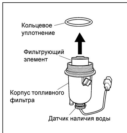
9. Смажьте моторным маслом новое кольцевое уплотнение и установите его в корпус топливного фильтра.
