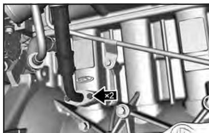
6. Открутите 1 крепежный болт между трубкой возврата масла и турбокомпрессором. Осторожно снимите трубку возврата масла с отверстия турбокомпрессора.
