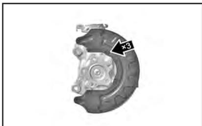
8. Открутите 4 крепежных болта (стрелка) между подшипником передней ступицы и поворотным кулаком.
