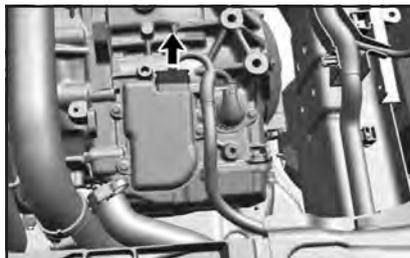
6. Открутите 3 крепежных болта (стрелка) электронного модуля переключения диапазонов передач.
