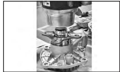
7. Извлеките фланец с помощью съемника.
