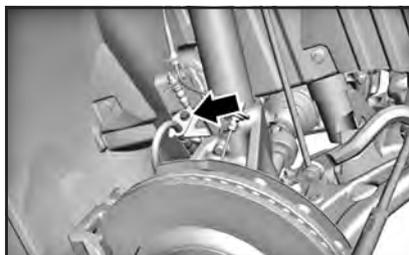
6. Снимите передний левый тормозной суппорт.
