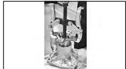
8. Снимите сальник фланца распределителя крутящего момента.
