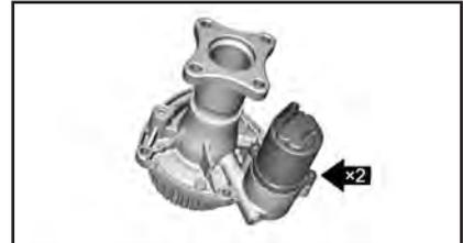
4. Снимите привод масляного насоса.
