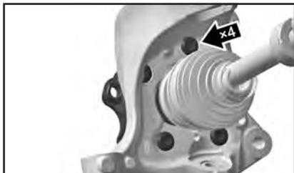
9. Снимите подшипник передней ступицы.
