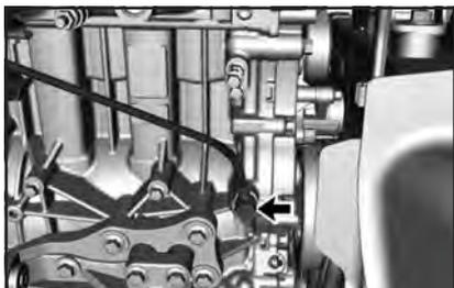
10. Открутите 2 крепежных болта на кронштейне подводящей масляной трубки.
