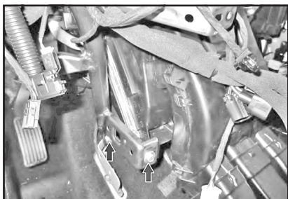
13. Открутите 2 гайки крепления блока к центральной части поперечины приборной панели.
