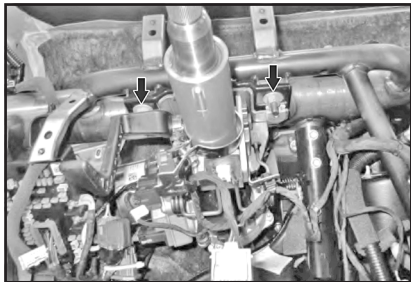
10. Открутите 1 болт крепления блока к рулевой колонке.
