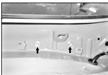
20. Открутите 7 болтов, открутите 2 гайки, снимите монтажную панель термоизолирующего мата моторного отсека.
