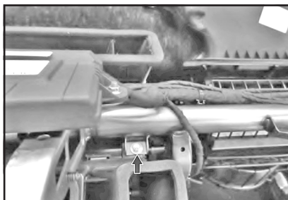
15. Открутите 1 гайку и 3 болта крепления блока к правой части поперечины приборной панели.
