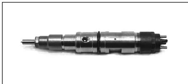
Неисправные форсунки можно отремонтировать в специализированной мастерской, при этом после ремонта вы должны получить новые корректирующие коды и прописать их в памяти блока управления двигателем. Корректирующий код для форсунки выдает стенд, если код не выдается, то ремонт выполнен неудовлетворительно.
