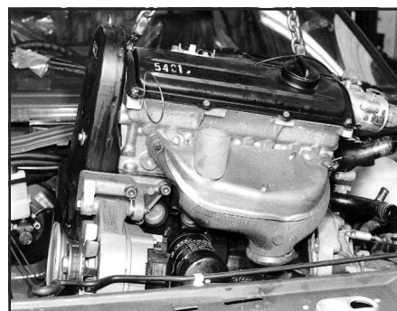
Рис. 5.28. Поднятие силового агрегата
