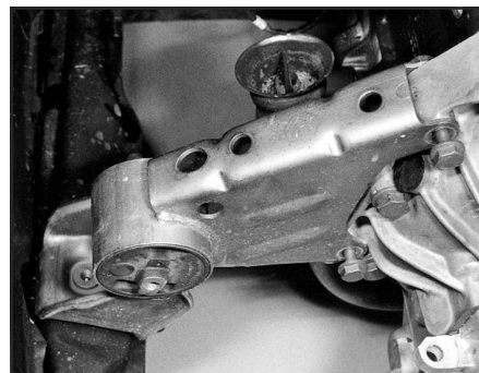
Рис. 5.26, б. Отверните и снимите узел опоры
