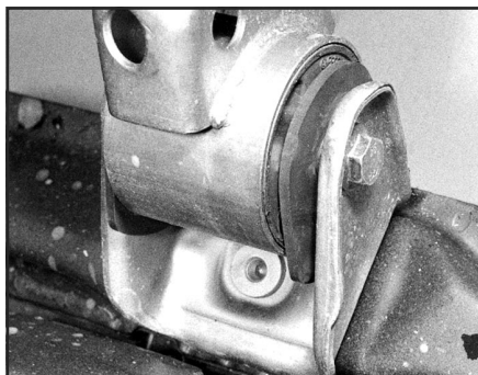
Рис. 5.26, а. Отверните сквозной болт передней опоры
