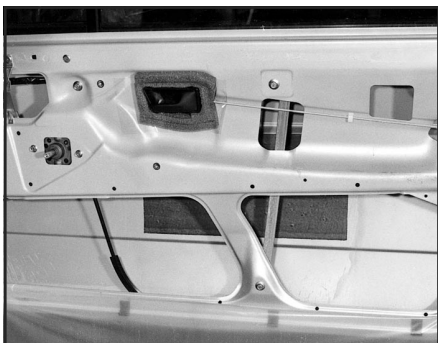
Рис. 14.10. Отведите пластиковую пленку, чтобы получить доступ к деталям двери
