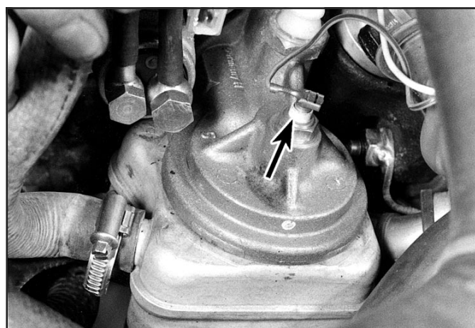
Рис. 5.39. Датчик указателя температуры масла (показан стрелкой)
