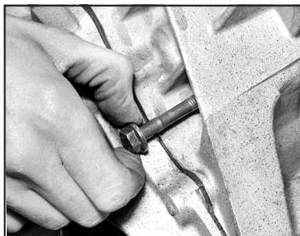
Рис. 6.6, а. Отверните болты крепления (показан утолщенный болт)...
