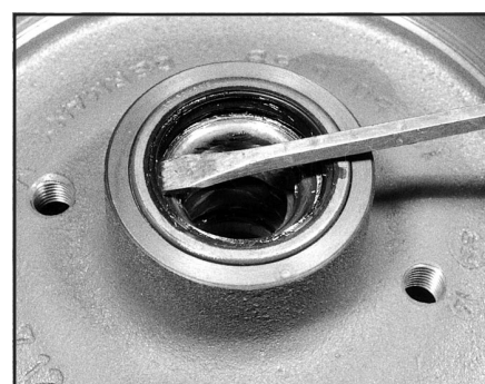
Рис. 8.3. Снятие масляной манжеты тормозного барабана
