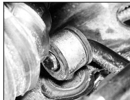
Рис. 4.5. Конец стабилизатора в проушине
