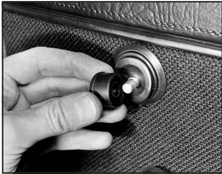
Рис. 14.5. Снятие кнопки регулятора зеркала двери
