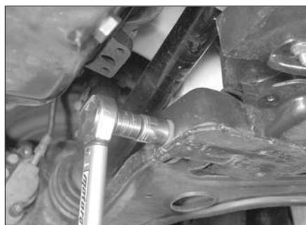
Рис. 5.14. Затяните шарнирный болт нижнего рычага требуемым моментом
