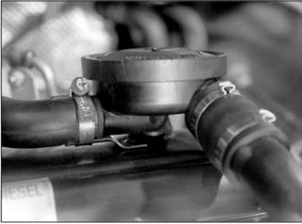
Рис. 7.2. Регулировочный клапан вентиляции картера
