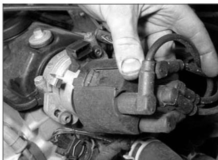
Рис. 4.6,а. Снятие крышки распределителя (показан двигатель ABD)
