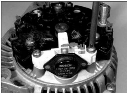
Рис. 6.4,а. Выверните винты сборки щеткодержатель/регулятор напряжения...
