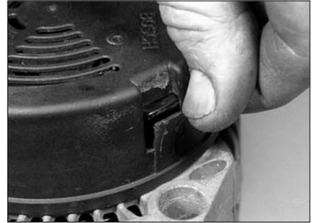
Рис. 6.3,б. ...затем отожмите фиксаторы
