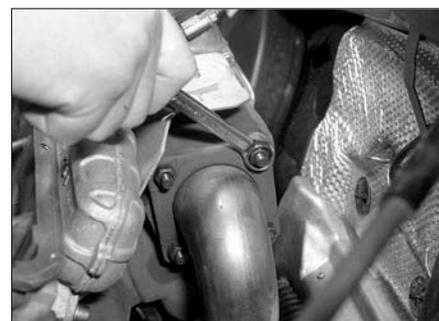
Рис. 6.7.а. Отверните гайки и отсоедините приемную трубу от выхода турбокомпрессора
