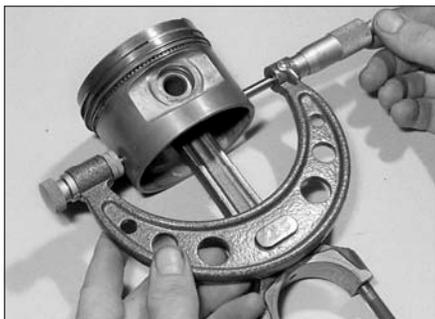
Рис. 5.18. Микрометром измерьте диаметры всех четырех поршней
