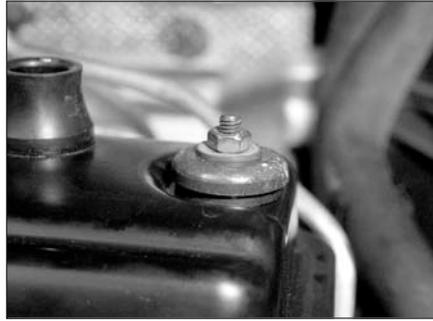
Рис. 7.3. Крепежная гайка крышки распределительного вала
