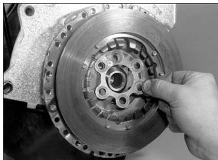
Рис. 6.15,б. ...затем установите промежуточную пластину...
