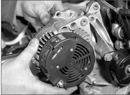
Рис. 5.5. Снятие генератора с кронштейна (показан дизельный двигатель)
