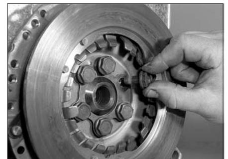
Рис. 6.15,в. ...и вверните комплект новых крепежных болтов
