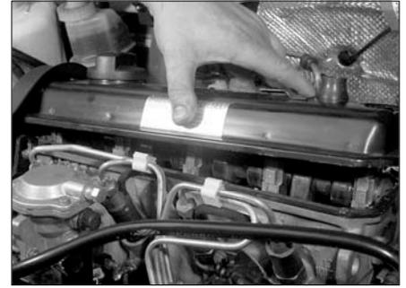
Рис. 7.4. Снимите крышку распределительного вала с головки цилиндров
