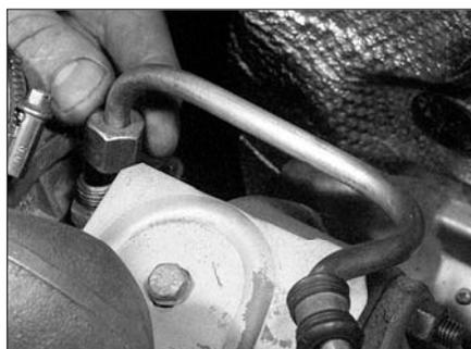
Рис. 6.6.б. Отсоединение питающего маслопровода от турбокомпрессора
