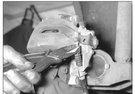
**Рис. 19.7.а. Отсоедините оболочку троса от рычага суппорта дискового тормоза...**
