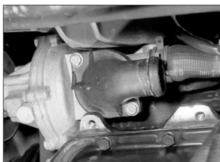
Рис. 4.10. Выверните крепежные болты и снимите крышку термостата
