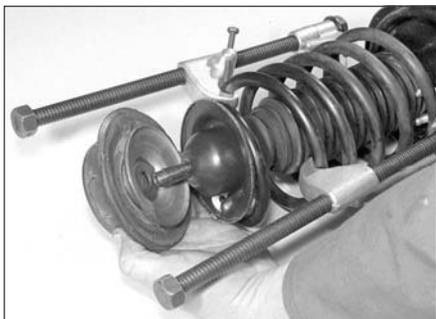
Рис. 4.19д. Установите в сборе верхнее крепление стойки...
