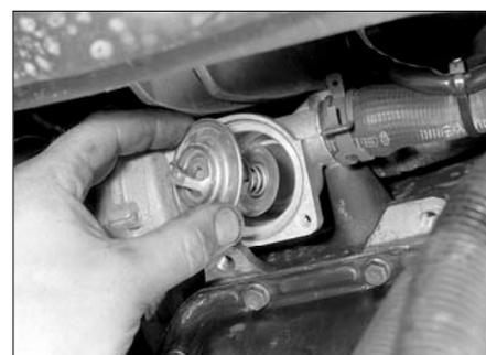
Рис. 4.11. Снимите уплотнительное кольцо и извлеките термостат из корпуса, обратив внимание на его ориентацию
