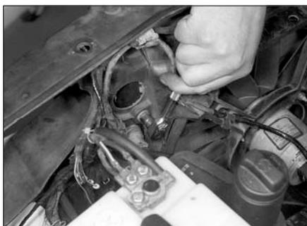
Рис. 3.8,а. Вывинчивание болта крепления радиатора
