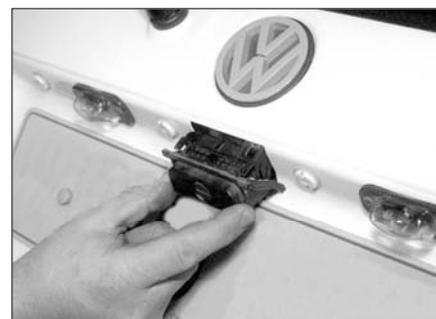
Рис. 16.5. ...затем отпустите фиксаторы и извлеките кнопку замка
