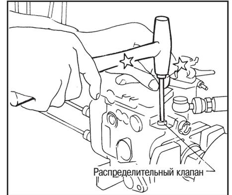
Протолкните внутрь корпуса распределительного клапана управляющую заглушку. Будьте внимательны, чтобы не переместить заглушку слишком далеко.
