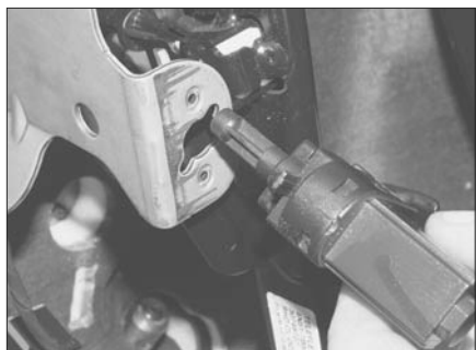
Рис. 2.7. Поверните датчик против часовой стрелки и снимите его
