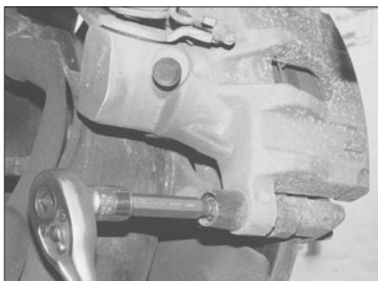
Рис. 5.2,в. Шестигранником отверните направляющие болты
