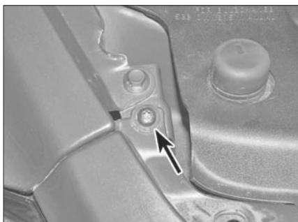
Рис. 22.3. Отверните винты (по одному с каждой стороны)
