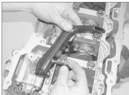
Рис. 13.3. Отверните болты крепления маслозаборника
