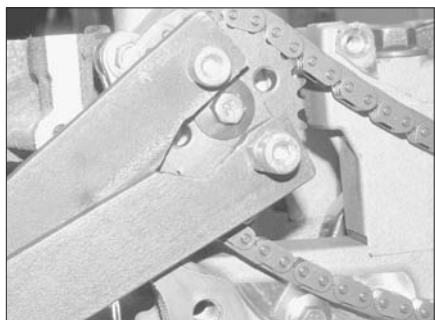
Рис. 13.5. Удерживая звездочку насоса, отверните болт ее крепления
