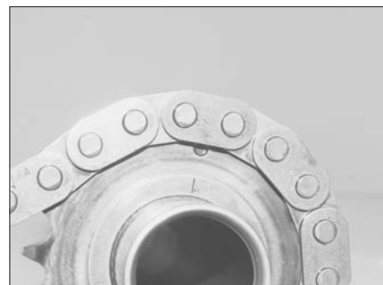
Рис. 7.26,б. ...с метками, нанесенными на звездочки
