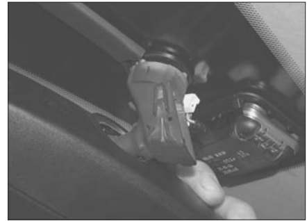
Рис. 21.13. Поверните основание зеркала на 90° и отсоедините его
