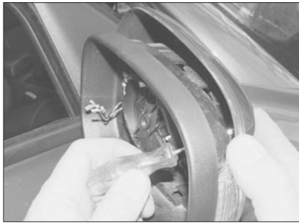
Рис. 21.7. Высвободите фиксатор и снимите кожух
