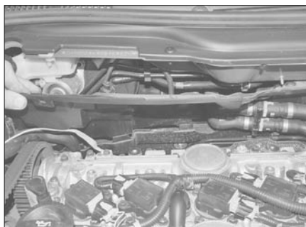
Рис. 2.2. Снимите звукоизоляционную панель со стенки моторного отсека
