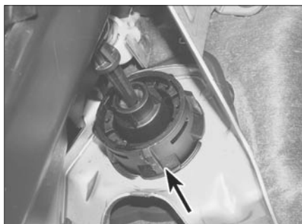
Рис. 2.11. Поверните главный цилиндр (указан стрелкой) против часовой стрелки
