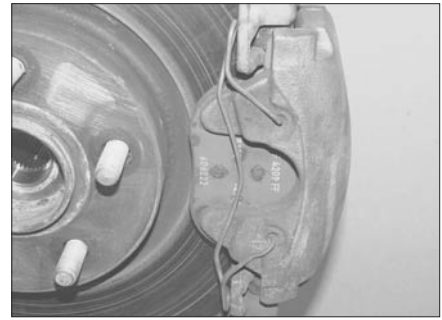
Рис. 4.2,р. ...установите пружинный фиксатор
