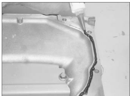
Рис. 12.8. Нанесите герметик на фланец поддона
