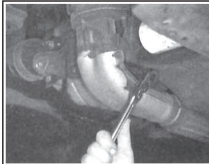
**Рис. 64 Открутите крепежный болт подвесного кронштейна...**
