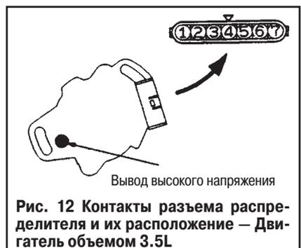
**Рис. 12** Контакты разъема распределителя и их расположение — Двигатель объемом 3.5L
