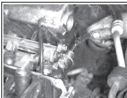
Рис. 38 ...и отсоедините шланг от регулятора давления топлива
