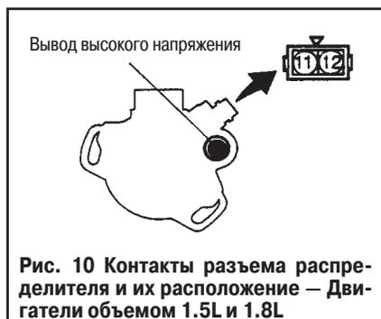
**Рис. 10** Контакты разъема распределителя и их расположение — Двигатели объемом 1.5L и 1.8L
