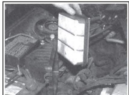
Рис. 41 Выньте фильтрующий элемент из кожуха воздушного фильтра
