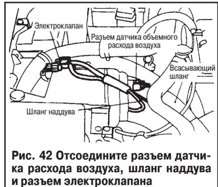
Рис. 42 Отсоедините разъем датчика расхода воздуха, шланг наддува и разъем электроклапана
