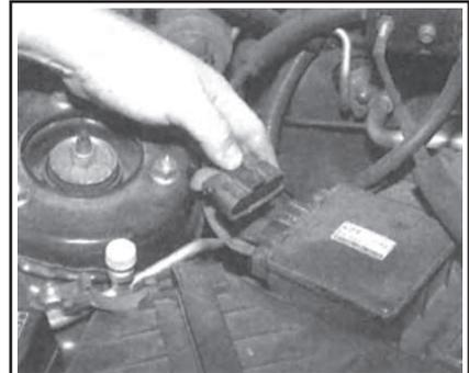
Рис. 37 Отсоедините разъем датчика MAF
