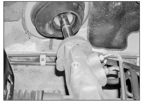
Рис. 4.23,в. Вывели вал рулевого управления из уплотнения, опуская подрамник
