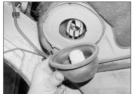
Рис. 4.25,б. Установите нижнюю часть резинового уплотнения, попросив помощника придержать верхнюю часть в салоне
