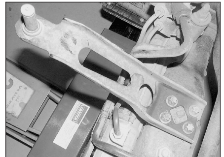
Рис. 4.24 Кронштейн механизма переключения передач на переднем подрамнике
