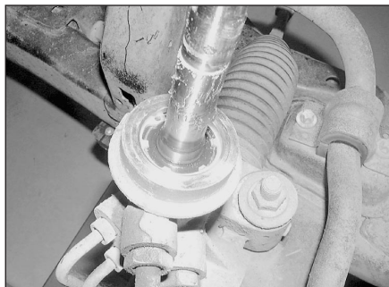
Рис. 4.25,а. Положение вала рулевого управления в резиновом уплотнении
