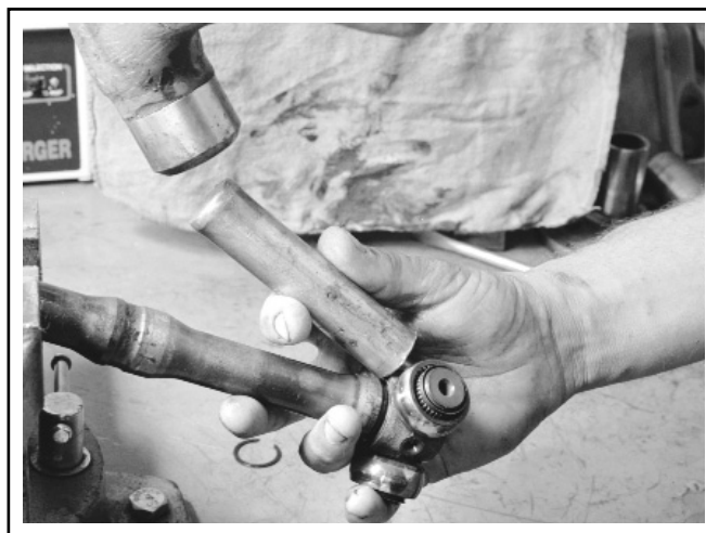
3.7. С помощью молотка и медной выколотки сбейте крестовину шарнира; не повредите на вале рабочие поверхности подшипника или шлицы
