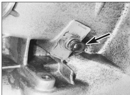
Рис. 8.5. Смажьте консистентной смазкой шаровую шпильку (коробки передач 012)
