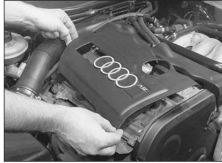
Рис. 2.8,б. ...и снимите верхнюю крышку двигателя (двигатели АDR)
