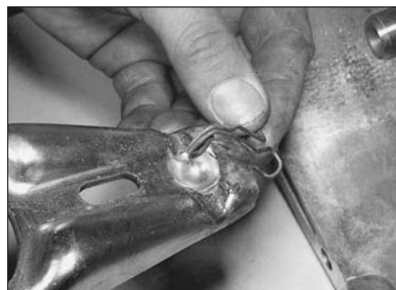
Рис. 8.6,а. На коробках передач 012 установите пружину на рычаг
