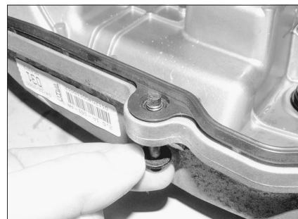
Рис. 5.12. Вставьте болты в отверстия во фланце и прокладку крышки головки цилиндров, проследив за тем, чтобы прокладка была правильно расположена в канавке
