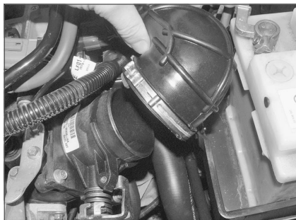
Рис. 6.5. Отпустите хомут и снимите трубопровод воздухозабора
