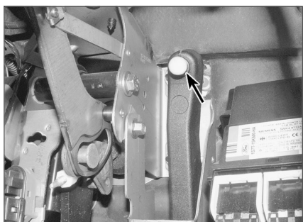
Рис. 9.7. Подсоединение троса акселератора к верхней части педали (вариант с правосторонним управлением)
