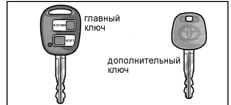
Комплект ключей для моделей с иммобилайзером и системой дистанционного управления замками дверей.
